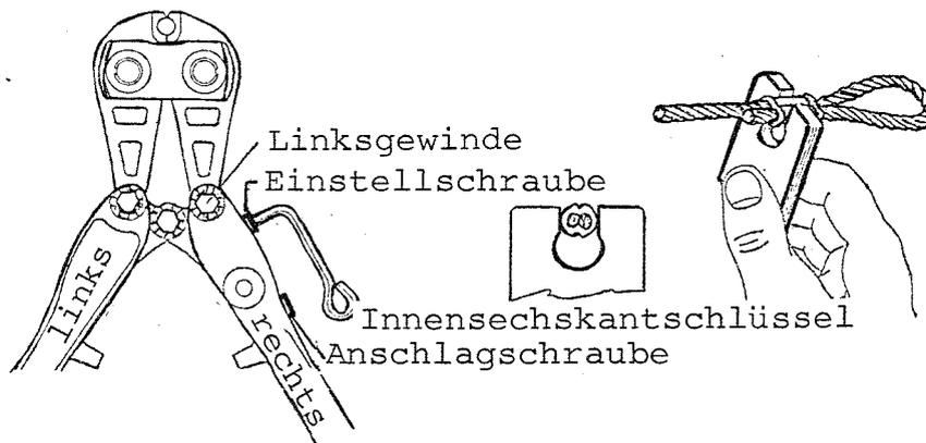
Bei geöffneten Griffen wird die Anschlagschraube mit dem Innensechskantschlüssel 1 bis 2 Umdrehungen gelöst. Dann wird die Einstellschraube etwa 1/4 Umdrehung in Uhrzeigerrichtung gedreht. Jetzt wird eine Pressung gemacht und mit Hilfe der Lehre überprüft. Falls erforderlich, muß die Einstellschraube weitergedreht werden, bis die Klemme in die Lehre hineinpaßt.
